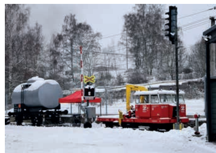
▲ Na cvičné koleji o délce 32 metrů si hasiči budou zkoušet taktiku zásahů v reálných podmínkách. Trenažér se železničním přejezdem se světelným výstražníkem, trolejovým vedením a funkčními návěstidly. Na samotné koleji jsou dva železniční vozy – cisterna a motorová drezína.
