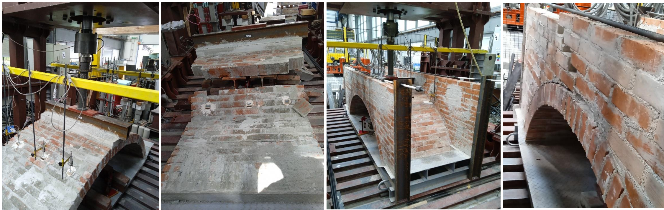
Obr. 29: Skúšanie vymurovaných tehlových experimentálnych klenieb bez bočných stienok a s bočnými stenkami.
