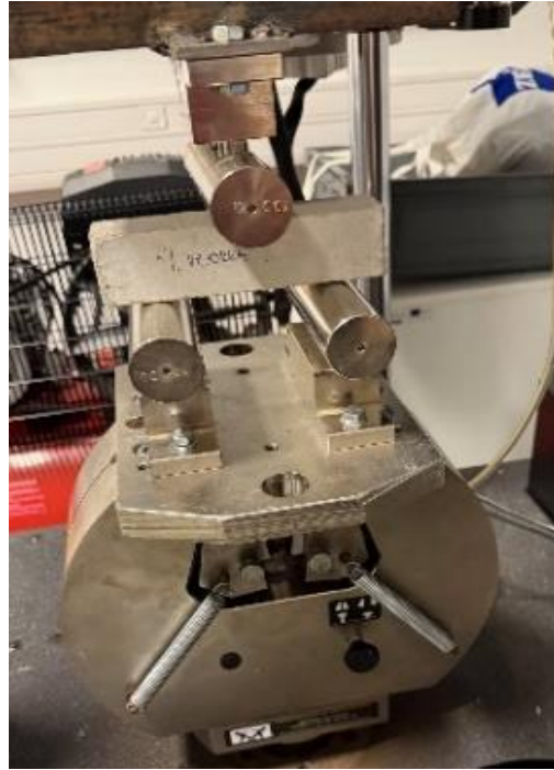
Obr. 25: Skúšanie pevnosti v ťahu pri ohybe trámčekov z malty.
