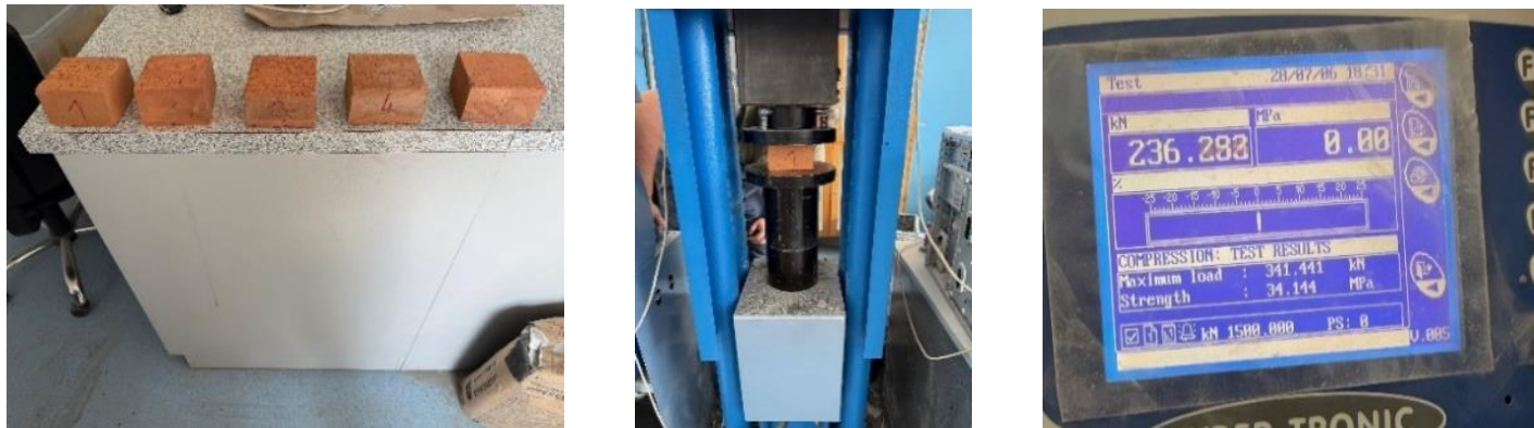
Obr. 24: Skúšanie pevnosti v tlaku murovacieho prvku.
