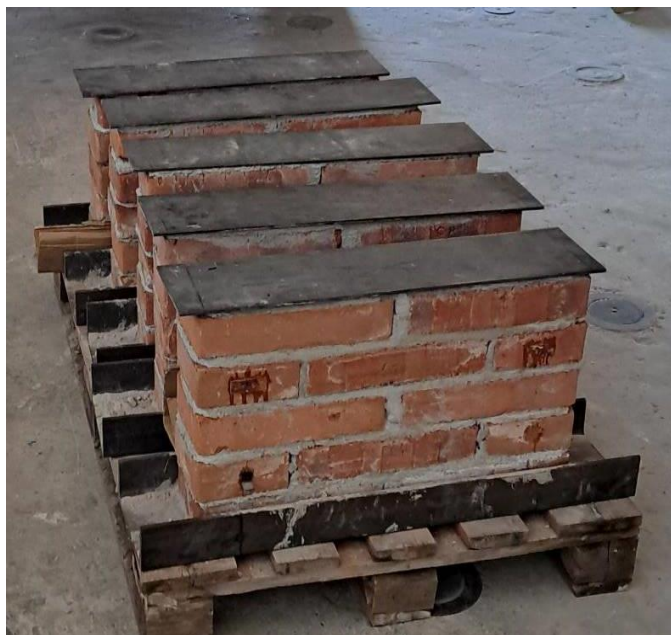
Obr. 27: Skúšanie pevnosti v tlaku muriva.
