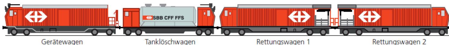
Lösch- und Rettungszug (LRZ) im Gotthard-Basistunnel
