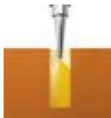
Umístění rychle tuhajícího plniva
