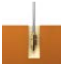
Čištění vrtaného otvoru
